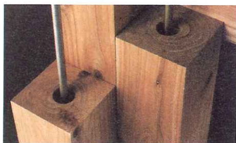
狂いや歪みのない無垢構造材「P-WOOD」。芯をくり抜き、内外から低温で約2週間かけて乾燥させ、堅牢な強さを宿す
