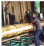
3. その木材に最も適した角材を得る為の製材
