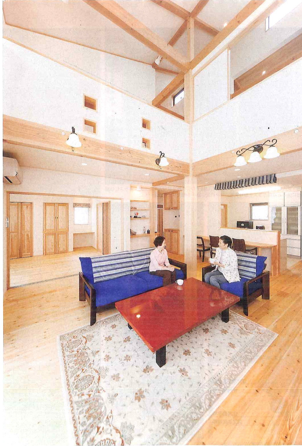
ホテルのロビーを思わせるような大きな吹き抜けと、赤松を用いた梁や床、檜の柱、杉の造作収納など、木の質感が印象的なLDK。壁には漆喰を採用。年齢を重ねても使いやすいように、できるだけ段差は無くし1階は全て引き戸にしてある（見開きページの写真は全てS氏邸）
