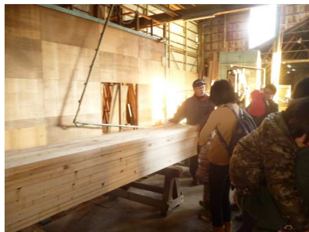
柱や床材に加工 燻煙乾燥された杉材 はピンクがかったきれいな色に変貌します。 そこが、燻煙乾燥の特徴です。
